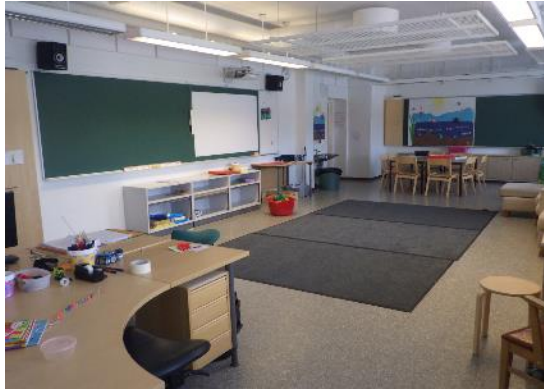
Kuvat 29 a ja b. Yleiskuvia. Välipohjarakenteiden lattiapäällysteenä opetustiloissa on käytetty muovimattoa ja vinyylilaattaa.
