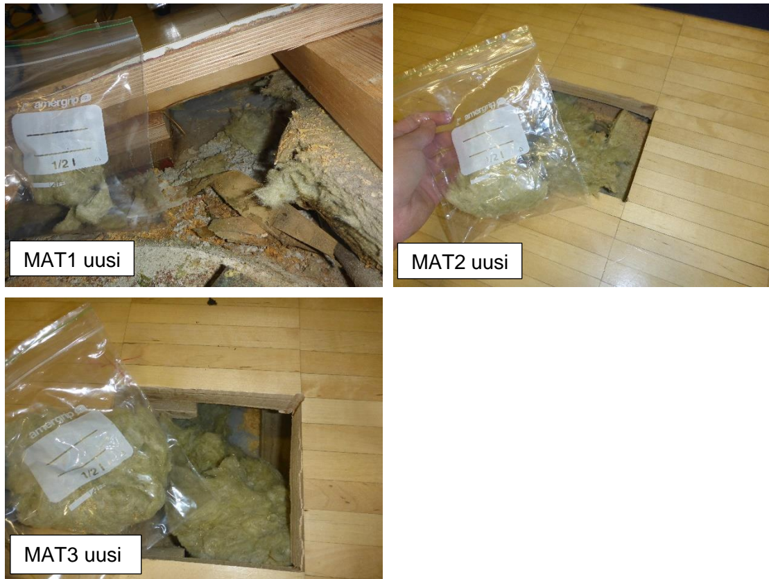
Kuva 3. Alapohjan lisämateriaalinäytteet otettiin liikuntasaliin tehdyistä rakenneavauksista. Materiaalinäytteiden numerointi noudattaa rakenneavausten numerointia. Kaikki näytteet otettiin betonilaatan ja muovikalvon päällä olevan kivivillan alapinnasta. Näytteessä 2 todettiin selvä mikrobikasvu materiaalissa, ja näytteissä 1 ja 3 ei todettu mikrobikasvua materiaalissa. Rakenneavauksista ei havaittu mikrobiperäistä tai muuten poikkeavaa hajua.
