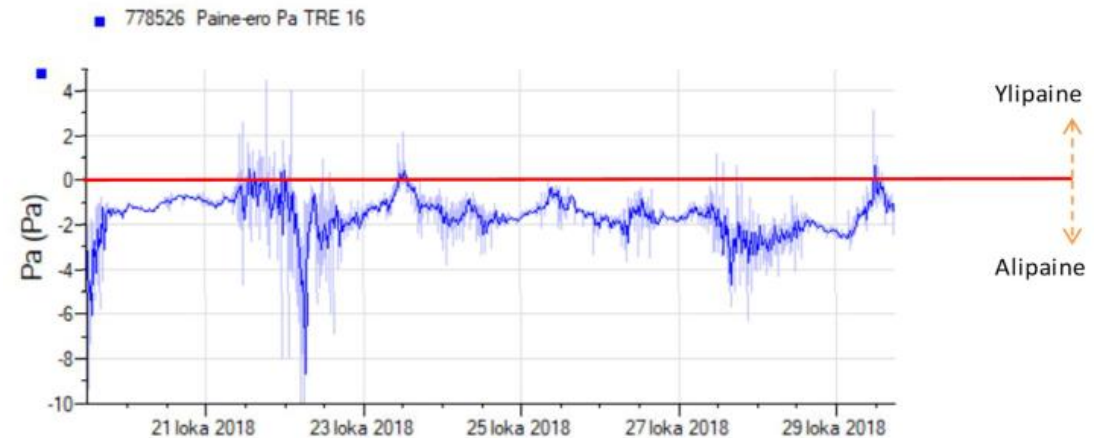
Kuvaaja 4. Tilan 104 (luokkahuone) paine-ero ulkoilmaan nähden toisen seuranta-mittausjakson aikana.
