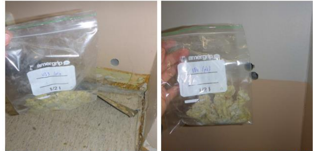
Kuva 38. Materiaalinäytteet MAT5 ja MAT6 otettiin näyttämön takaosasta. Näyte MAT5 otettiin seinän alaosaan ja MAT6 sivusuunnassa samalta kohtaa, mutta noin metrin korkeudelta lattiasta. Materiaalinäytteiden MAT3 ja MAT4 näytteenottokohdat on valittu tilassa 067 samalla tavalla: MAT3 seinän alaosaan ja MAT4 noin metrin korkeudelta lattiasta. Rakennearvauksista ei havaittu mikrobiperäistä tai muuten poikkeavaa hajua.
