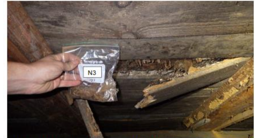
Kuva 12. Ryömintätilan kautta otettiin näytteet N3 (RAK6) ja N4 (RAK7). Molemmat näytteet otettiin aluslaudoituksen ja tervapaperin yläpuolelta alapohjan eristekerroksen alaosasta. Näytteestä N4 ei ole valokuvaa. Analyysiraportin mukaan molemmissa näytteissä havaittiin epäily mikrobikasvusta.
