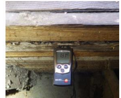
Kuvat 24 a ja b. Viiltomittaus V3 tila 203. Viiltomittauksen tulos 32,6 %RH. Hyvä tartunta, ei poikkeavaa hajua, murtopinta liimassa.
