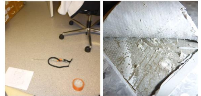
Kuvat 24 a ja b. Viiltomittaus V3 tila 203. Viiltomittauksen tulos 32,6 %RH. Hyvä tartunta, ei poikkeavaa hajua, murtopinta liimassa.
