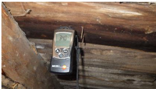
Kuva 60 a ja b. Pistokoeluontoisten kosteusmittausten perusteella osa tummentuneista kohdista on märkiä. Pääosin aluslaudoitus on aistinvaraisesti arvioiden lujaa. Yksittäisissä kohdissa havaittiin puurakenteissa pehmentymistä / lahoa.
