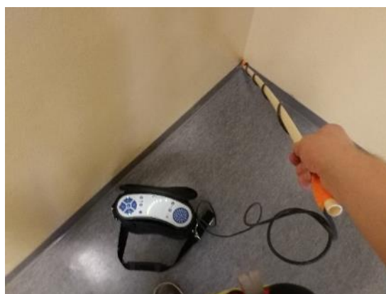
Kuva 24 a ja b. Vasemmalla voimakasta ilmavuotoa portaikon edustalla. Oikean puoleisessa kuvassa voimakasta ilmavuotoa tilan 103 Opetustila ja 106 WC kulmassa.
