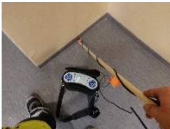
Kuva 22 a ja b. Voimakasta ilmavuotoa tilan 102a komero seinän ja lattia liittymässä tilan 102 Ala-aula puolelta mitattuna.
