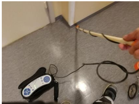
Kuva 25 a ja b. Musiikkiluokan (tila 103) oven karmien reunoista havaittiin voimakasta ilmavuotoa.
