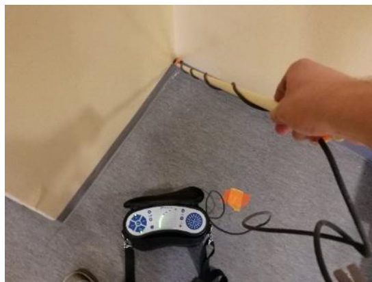
Kuva 22 a ja b. Voimakasta ilmavuotoa tilan 102a komero seinän ja lattia liittymässä tilan 102 Ala-aula puolelta mitattuna.
