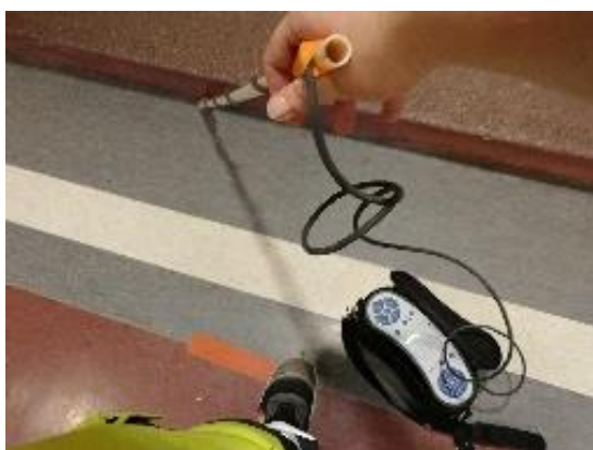
Kuva 24 a ja b. Vasemmalla voimakasta ilmavuotoa portaikon edustalla. Oikean puoleisessa kuvassa voimakasta ilmavuotoa tilan 103 Opetustila ja 106 WC kulmassa.
