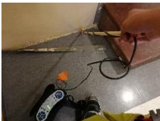
Kuva 23 a ja b. Voimakasta ilmavuoto portaikon vasemmassa reunassa.
