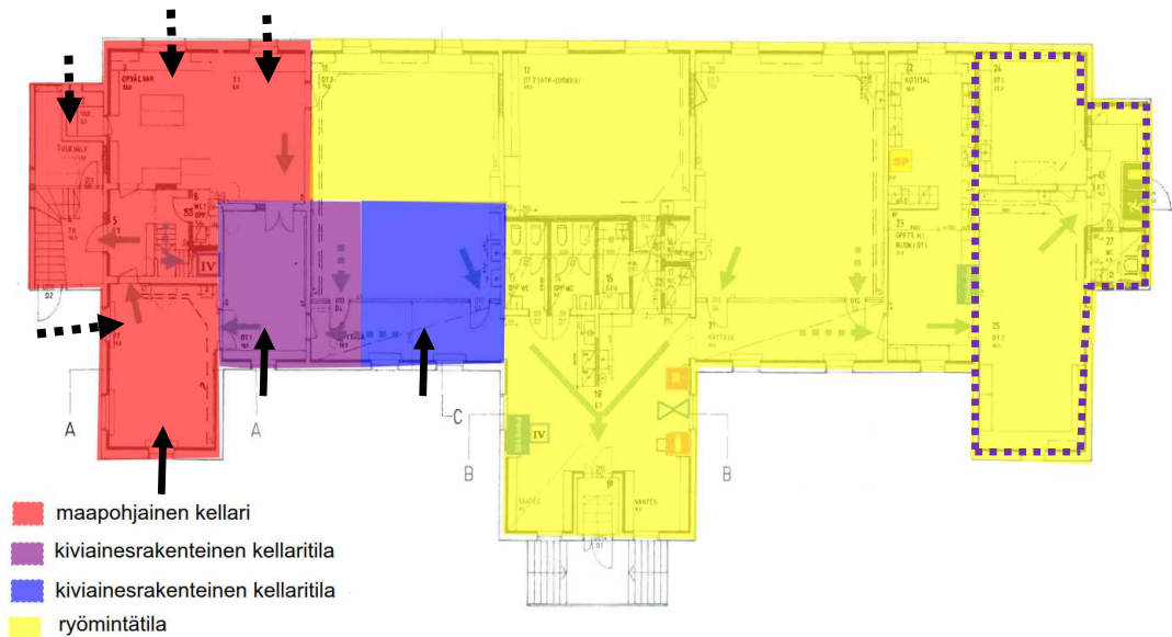
Kuva 5. Rakennuksen kellaritilat. Kellaritiloihin on kulku etupihan puolelta nuolien osoittamista kohdista. Rakennuksen takana on lukittuja/ummistettuja luokkuja ja ovi, merkitty katkoviivoitetuilla nuolilla. Lattiarakenne ja alapohjarakenteen täyttökerroksen pintaosia on uusittu rakennuksen itäpäädyssä katkoviivoitetulla alueella.
