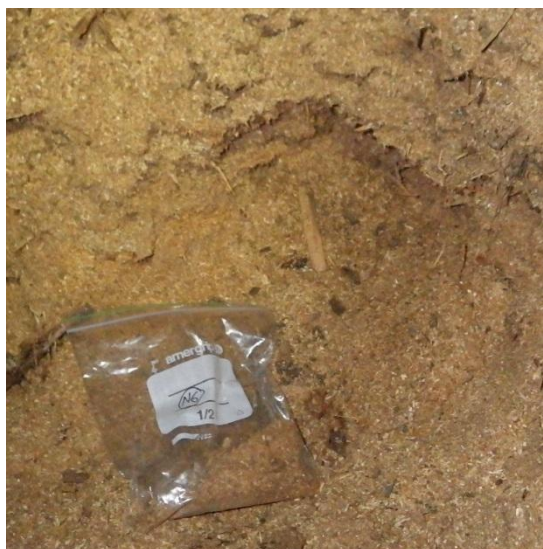
Kuva 26. Yläpohjan eristeestä otettiin näytteet N5 ja N6. Molemmat näytteet otettiin ullakkotilasta käsin alueelta, jossa oli alkuperäistä sahanpurueristettä. Analyysiraportin mukaan molemmissa näytteissä havaittiin epäily mikrobikasvusta. Eristeestä havaittiin näytteenottokohdalla kyseiselle eristemateriaalille tyypillinen lievästi tunkkainen haju.
