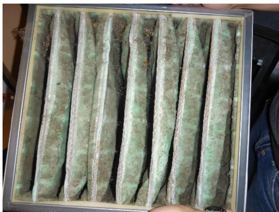
Kuva 32 a ja b. Tulo- ja poistoilmasuodattimet ovat luokkaa EU7.
