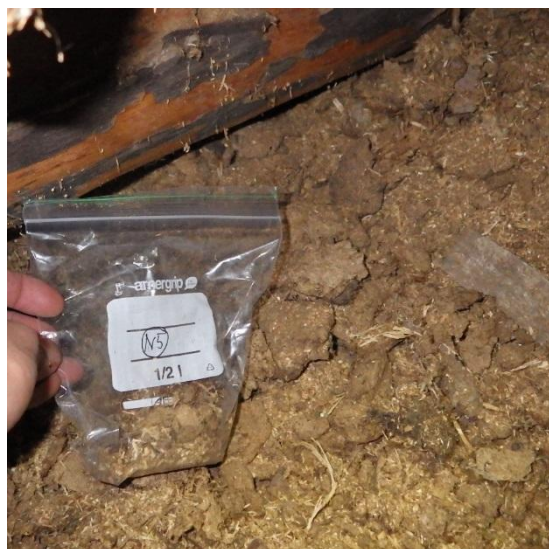
Kuva 26. Yläpohjan eristeestä otettiin näytteet N5 ja N6. Molemmat näytteet otettiin ullakkotilasta käsin alueelta, jossa oli alkuperäistä sahanpurueristettä. Analyysiraportin mukaan molemmissa näytteissä havaittiin epäily mikrobikasvusta. Eristeestä havaittiin näytteenottokohdalla kyseiselle eristemateriaalille tyypillinen lievästi tunkkainen haju.
