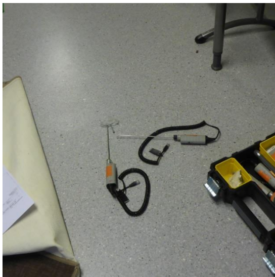
Kuvat 25 a ja b. Viiltomittaus V4 tila 206. Viiltomittauksen tulos 32,5 %RH. Kohtalainen tartunta, ei poikkeavaa hajua, murtopinta liimassa.
