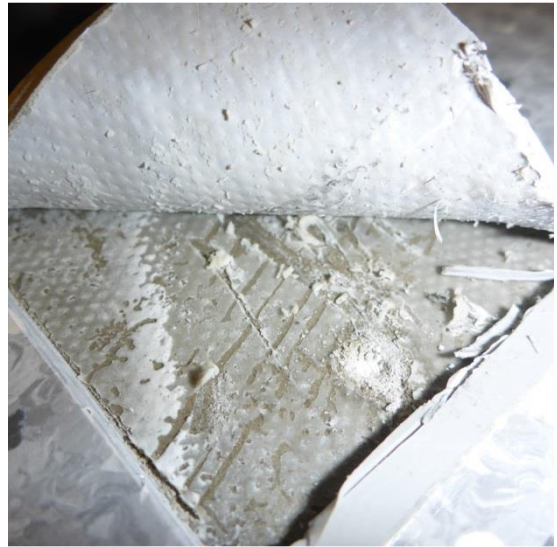
Kuvat 24 a ja b. Viiltomittaus V3 tila 203. Viiltomittauksen tulos 32,6 %RH. Hyvä tartunta, ei poikkeavaa hajua, murtopinta liimassa.
