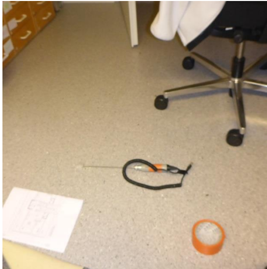
Kuvat 24 a ja b. Viiltomittaus V3 tila 203. Viiltomittauksen tulos 32,6 %RH. Hyvä tartunta, ei poikkeavaa hajua, murtopinta liimassa.
