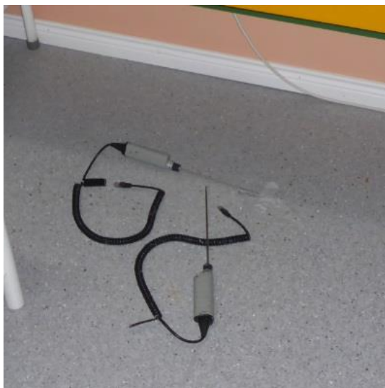
Kuvat 22 a ja b. Viiltomittaus V1 tila 106. Viiltomittauksen tulos 36,7 %RH. Kohtalainen tartunta, ei poikkeavaa hajua, murtopinta liimassa.
