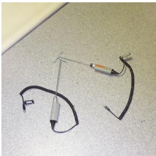
Kuvat 23 a ja b. Viiltomittaus V2 tila 108. Viiltomittauksen tulos 39,6 %RH. Kohtalainen tartunta, ei poikkeavaa hajua, murtopinta liimassa.
