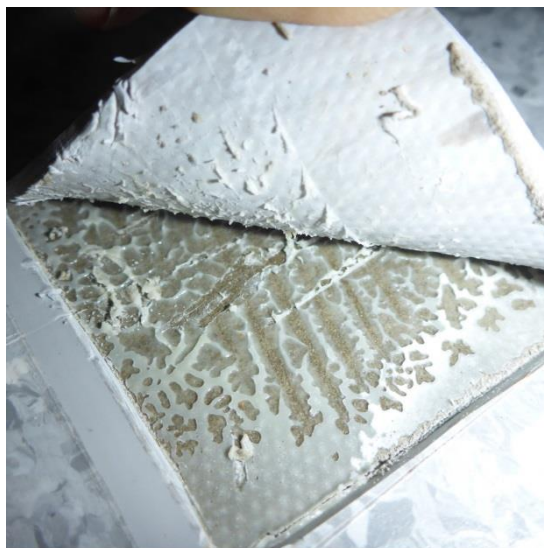
Kuvat 22 a ja b. Viiltomittaus V1 tila 106. Viiltomittauksen tulos 36,7 %RH. Kohtalainen tartunta, ei poikkeavaa hajua, murtopinta liimassa.
