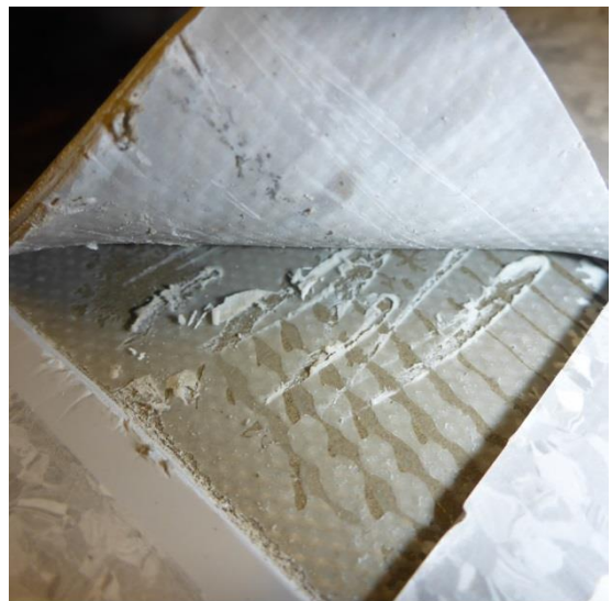
Kuvat 25 a ja b. Viiltomittaus V4 tila 206. Viiltomittauksen tulos 32,5 %RH. Kohtalainen tartunta, ei poikkeavaa hajua, murtopinta liimassa.
