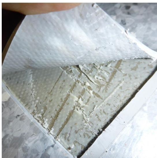
Kuvat 23 a ja b. Viiltomittaus V2 tila 108. Viiltomittauksen tulos 39,6 %RH. Kohtalainen tartunta, ei poikkeavaa hajua, murtopinta liimassa.
