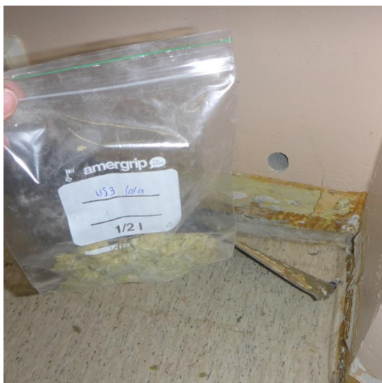
Kuva 38. Materiaalinäytteet MAT5 ja MAT6 otettiin näyttämön takaosasta. Näyte MAT5 otettiin seinän alaosasta ja MAT6 sivusuunnassa samalta kohtaa, mutta noin metrin korkeudelta lattiasta. Materiaalinäytteiden MAT3 ja MAT4 näytteenottokohdat on valittu tilassa 067 samalla tavalla: MAT3 seinän alaosasta ja MAT4 noin metrin korkeudelta lattiasta. Rakenneseinävauksista ei havaittu mikrobiperäistä tai muuten poikkeavaa hajua.
