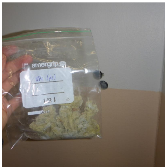
Kuva 38. Materiaalinäytteet MAT5 ja MAT6 otettiin näyttämön takaosasta. Näyte MAT5 otettiin seinän alaosasta ja MAT6 sivusuunnassa samalta kohtaa, mutta noin metrin korkeudelta lattiasta. Materiaalinäytteiden MAT3 ja MAT4 näytteenottokohdat on valittu tilassa 067 samalla tavalla: MAT3 seinän alaosasta ja MAT4 noin metrin korkeudelta lattiasta. Rakenneseinävauksista ei havaittu mikrobiperäistä tai muuten poikkeavaa hajua.
