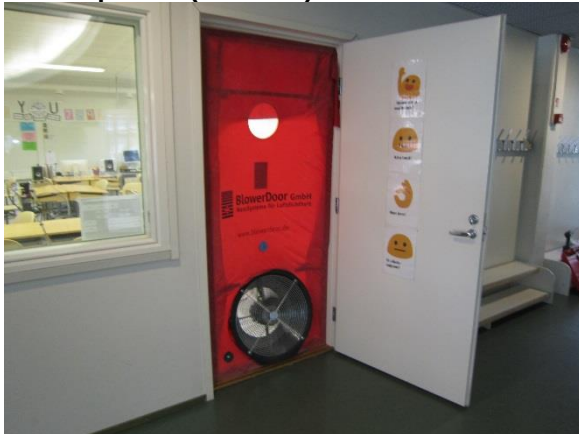
Kuva 30. Puhallin asennettu oviaukon kohdalle
