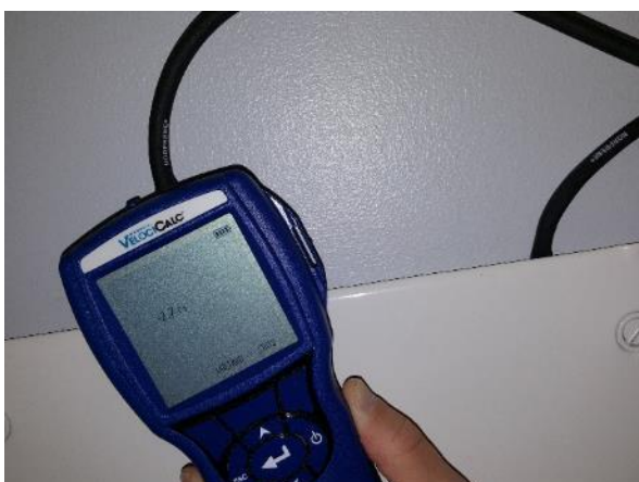
Kuva 33. Tilan 210 (OPO 1) kotelo on lievästi alipaineinen ( \sim -3 Pa) sisäilmaan verrattuna, eli ilma liikkuu kotelosta tilaan päin.
