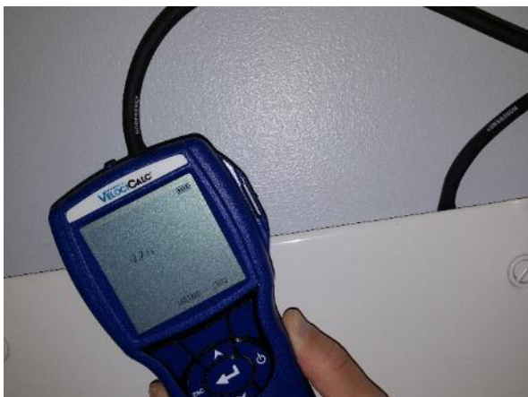
Kuva 33. Tilan 210 (OPO 1) kotelo on lievästi alipaineinen (~-3 Pa) sisäilmaan verrattuna, eli ilma liikkuu kotelosta tilaan päin.
