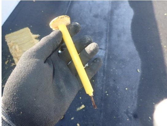
Kuvat 23 a ja b. Rakenneavauksessa RA4 havaittiin vedeneristeen kiinnike, joka oli alaosastaan ruostunut ja katkennut. Muissa avauksissa ei havaittu kiinnikkeitä, mikä viittaa siihen, että katossa ei todennäköisesti ole riittävää tai ohjeiden mukaista määrää kiinnikkeitä.
