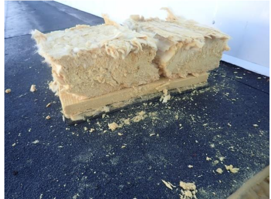
Kuvat 25 a ja b. Rakenneavauksissa ei havaittu erillistä tuuletusuritutusta mineraalivillaeristeissä. Eristeet olivat avauksissa aistinvaraisesti arvioiden kaikissa avauksissa kuivia eikä niissä havaittu viitteitä kosteusrasituksesta tai ilmavuodoista. Kuvassa b rakenneavauksesta purettu eristeet käännettynä ylösalaisin.
