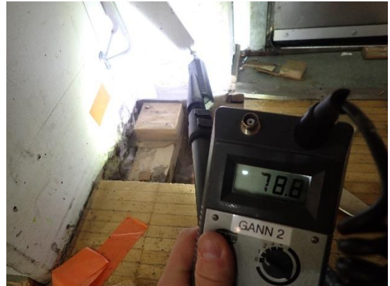
Kuvat 10 a ja b. Pintakosteuskartoituksen tuloksia rakenneavauksessa RA1. Betonirakenteiden (laatta, pilari, sokkeli) mittaustulokset olivat avauksessa lattiapinnan alapuolella merkittävästi koholla, välillä 100...140. Lattiapinnan yläpuolella tulokset seinä- ja pilaripinnoilla olivat selkeästi matalammat, välillä 65...80.
