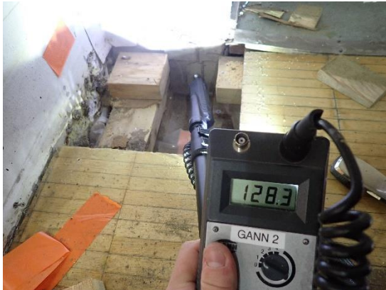
Kuvat 10 a ja b. Pintakosteuskartoituksen tuloksia rakenneavauksessa RA1. Betonirakenteiden (laatta, pilari, sokkeli) mittaustulokset olivat avauksessa lattiapinnan alapuolella merkittävästi koholla, välillä 100...140. Lattiapinnan yläpuolella tulokset seinä- ja pilaripinnoilla olivat selkeästi matalammat, välillä 65...80.
