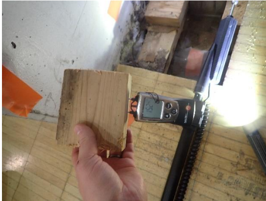
Kuvat 9 a ja b. Rakenneavauksessa RA1 mitatut puurakenteiden kosteuspitoisuudet olivat koholla, mitaustulokset vaihtelivat välillä 15...25 %. Korkeimmat tulokset mitattiin läheltä ympäröiviä betonirakenteita. Kuvissa esiintyy samasta katkaistusta joustolattian runkopuusta eri puolilta mitatut tulokset 15...25 %.
