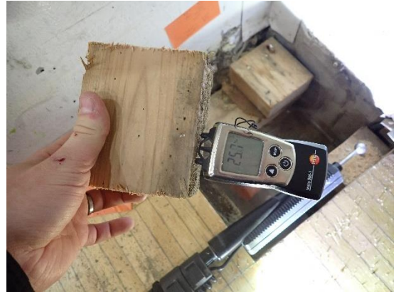
Kuvat 9 a ja b. Rakenneavauksessa RA1 mitatut puurakenteiden kosteuspitoisuudet olivat koholla, mitaustulokset vaihtelivat välillä 15...25 %. Korkeimmat tulokset mitattiin läheltä ympäröiviä betonirakenteita. Kuvissa esiintyy samasta katkaistusta joustolattian runkopuusta eri puolilta mitatut tulokset 15...25 %.
