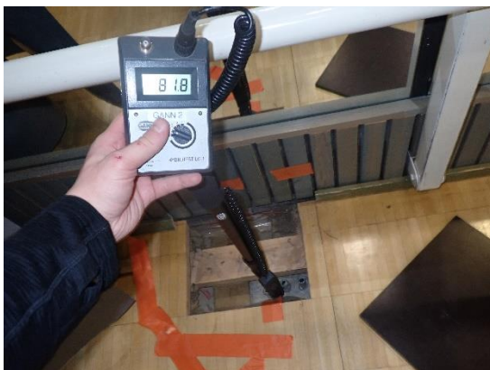
Kuvat 14 a ja b. Pintakosteusosoittimen lukemat vaihtelivat rakenneavauksessa RA2 joustolattiapinnan alapuolella 65-90. Lattiapinnan lukemat olivat hieman koholla. Puuosat olivat kuivia, kosteuspitoisuudet olivat n. 10 %.
