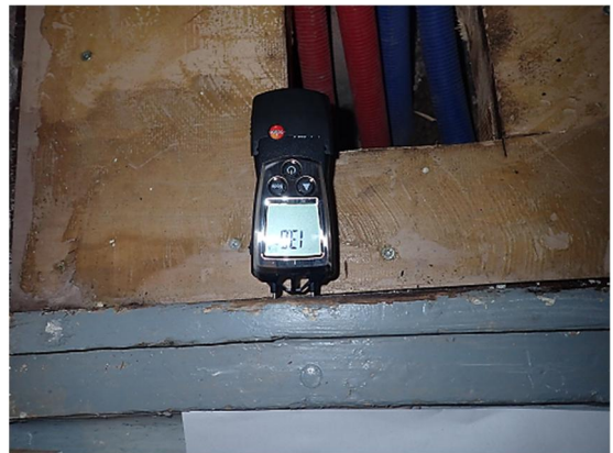
Kuvat 8 a ja b. Toimiston 112 komeron kynnyks on tummunut. Piikkimittarilla tarkasteltuna puun kosteus on normaali (n. 13 p %).
