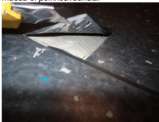
Kuva 15. V3, 84,4 % RH. Ei poikkeavaa hajua, matto irti alustastaan. Kiinnitysliimassa ei poikkeavuuksia.
