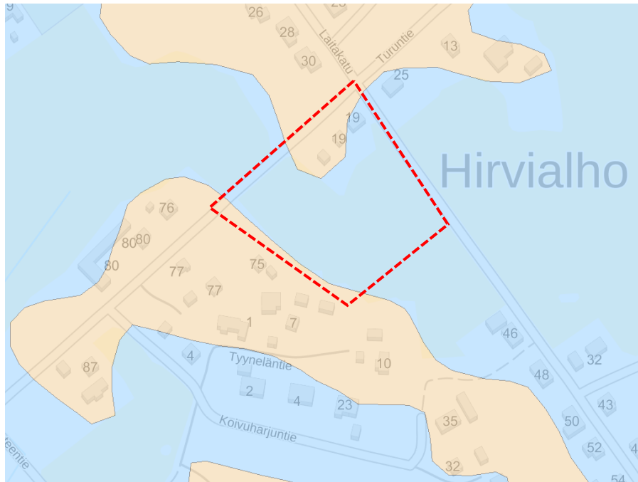
Kuva 6. Ote GTK:n Maankamara-karttapalvelusta. Ruskealla esitettyä hiekkamoreenialueita, ja sinisellä savialueita. Kaava-alueen rajaus merkitty likimääräisesti punaisella katkoviivalla.
