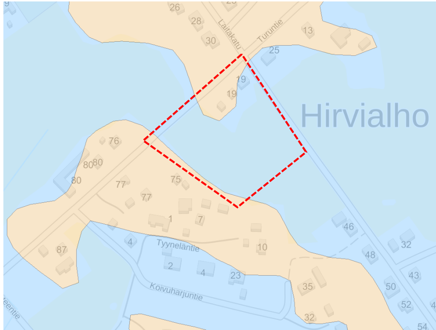
Kuva 6. Ote GTK:n Maankamara-karttapalvelusta. Ruskealla esitettyinä hiekkamoreenialueet, ja sinisellä savialueet. Kaava-alueen rajaus merkitty likimääräisesti punaisella katkoviivalla.
